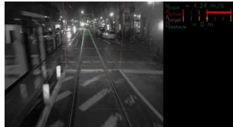
Bombardiers Fahrerassistenzsystem für Straßenbahnen, Frankfurt
