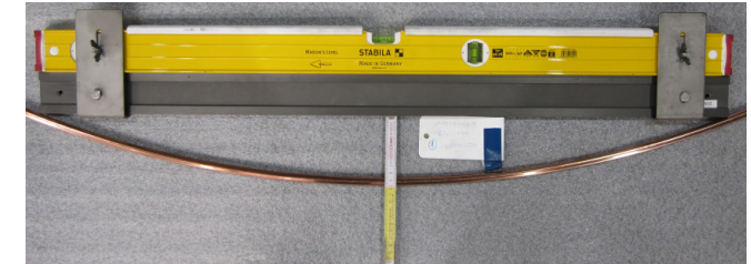
Nach Zugbelastung und Entlastung
