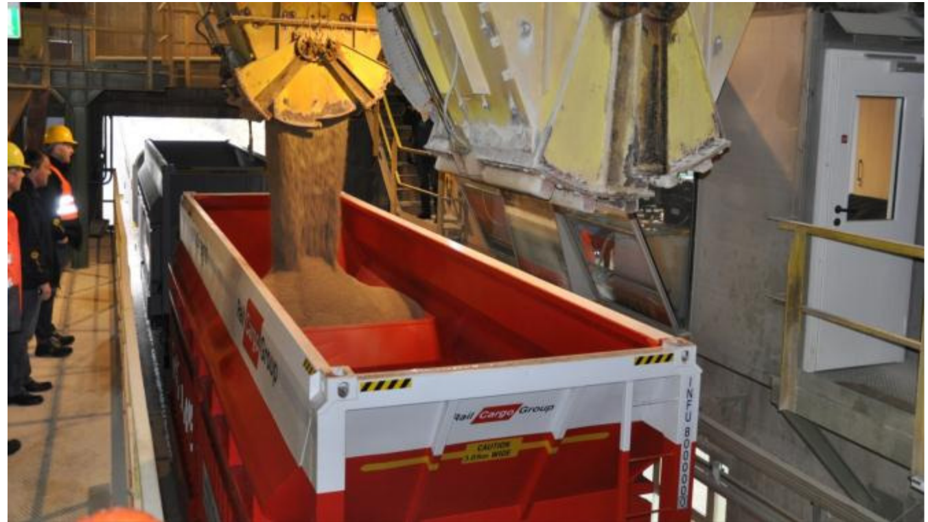
Mischerzbeladung in Eisenerz
