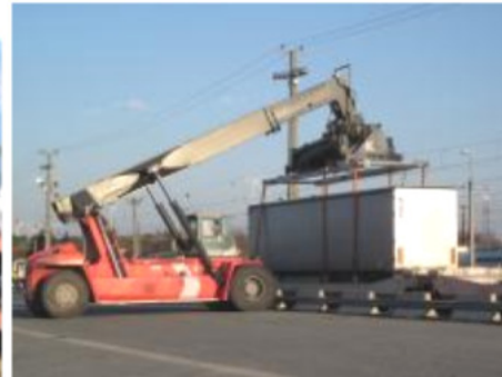
Innovativer Sattel- aufleger Umschlag (ISU) das Heben von nicht kranbaren Sattelauflegern
