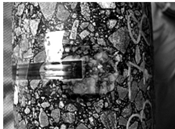
Abbildung 1: Probekörper für einen TCCT mit appliziertem Dehnungsmessstreifen.
