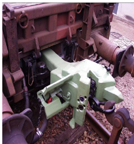
Abb. 3: Moderner Kupplungstyp TRANSPACT (C-AKv)
