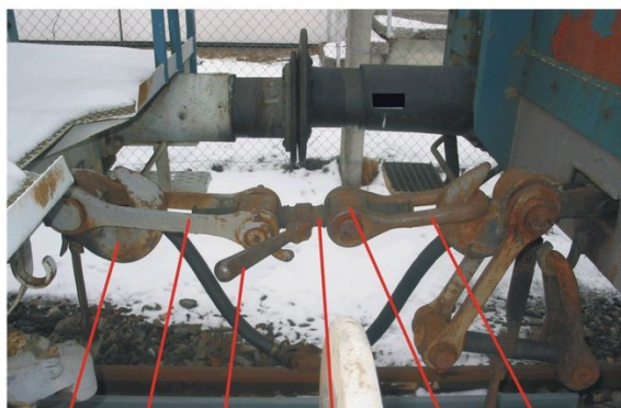
Zughaken / Schwengel Spindel Mutter Bügel Lasche
