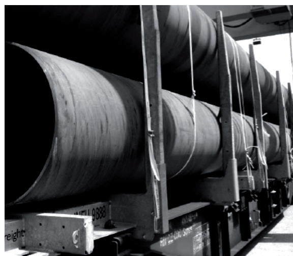
Abb. 5: Palettensystem Rohrtransporte mit 60 ft Waggons
