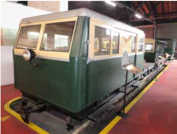
Motorbahnwagen BM20, nach 1938 gebaut, im Zustand nach dem Umbau in den 1950er Jahren.
