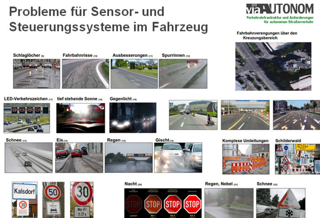
Abbildung 12: Problemsituationen für Sensoren 2
