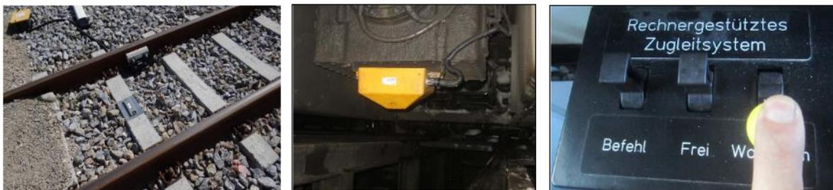
Abbildung 16: Balise und Achszähler im Gleis, Lesegerät am Tfz, Taster für Zugbeeinflussung mit PZB-Funktionalität. Fotos Otfried Knoll, Walter Stramitzer
