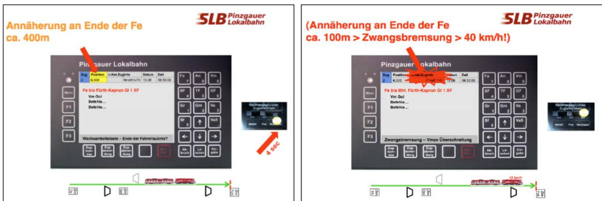
Abbildung 18: Überwachung des Gültigkeitsbereiches der Fahrerlaubnis. Grafiken: FH Wels, Siemens, PLB
