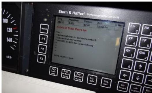
Abbildung 11: DMI des ZLS StH mit Eingabetasten und Klartextanzeige der Zuglaufmeldungen sowie zusätzlichen Aufträgen für den Tzfz auf der vernetzten Strecke Lambach – Vorchdorf. (Foto: Otfried Knoll)
