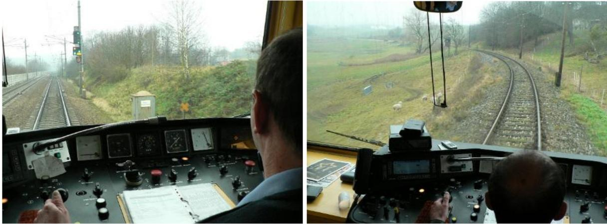
Abbildung 8: Übergang mittels Zweisystemfahrzeugen von AC-elektrifizierter Hauptbahn mit PZB-Zugsicherung auf DC-elektrifizierte Lokalbahn mit Zugleitbetrieb. Fotos: Otfried Knoll, 2009.
