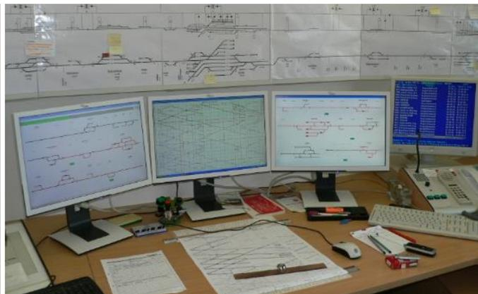
Abbildung 9: Klartextanzeige der aus dem 8-Ton-Telegramm übersetzten Zuglaufmeldungen mit Ortsangabe und Zeitmarke für den Fdl (Foto: Otfried Knoll, 1992)
