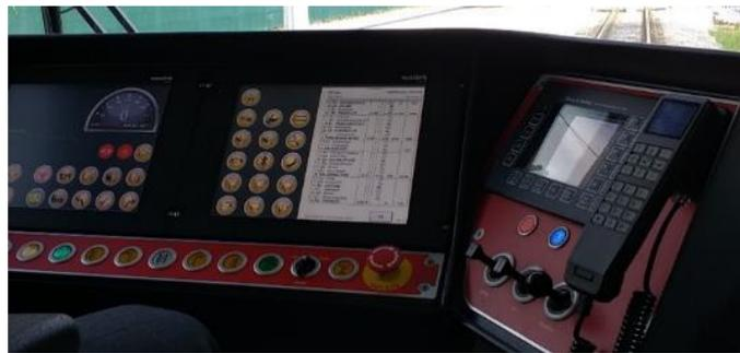
Abbildung 12: Integration des ZLS-DMI im Führerstand: In Bildmitte der elektronische Buchfahrplan, rechts das DMI mit den PZB-ähnlichen Funktionstasten, ganz rechts die Zugfunkeinrichtung. (Foto: Otfried Knoll)
